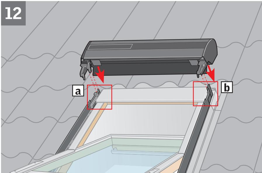
Das Rollladen-Oberteil in die Führungsnuten der Seitenbleche einsetzen **a**. Die Gummischürze muss **glatt** und **dicht** am Eindeckrahmen-Oberteil anliegen **b**.
