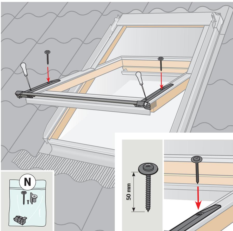
Sturmbeschläge und unteres Abdeckblech provisorisch mit Schrauben in den oberen Löchern montieren. Die unteren Löcher mit Dorn markieren.
