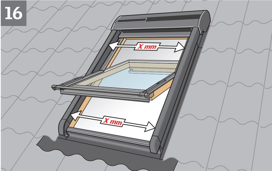
Darauf achten, dass der Abstand zwischen den seitlichen Führungsschienen oben und unten gleich ist (**X mm = X mm**).
