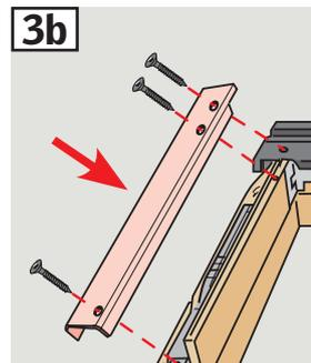
**Nur bei VK:** Seitenbleche jetzt mittig am Fenster festschrauben. Durch das gezeigte Loch bohren **1b**. Obere Schraube hier eindrehen **2b**. U-Abdeckbleche mit den vorhandenen Schrauben montieren **3b**.
