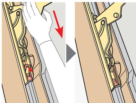
**Nur bei VK:** Federn einkuppeln. Flügel nach oben drücken und gleichzeitig Beschläge nach unten ziehen, bis sie in beiden Seiten mit den Federn einrasten.
