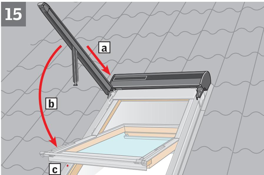
Seitliche Führungsschienen in Position schieben **a** und auf die Seitenbleche legen **b**.
