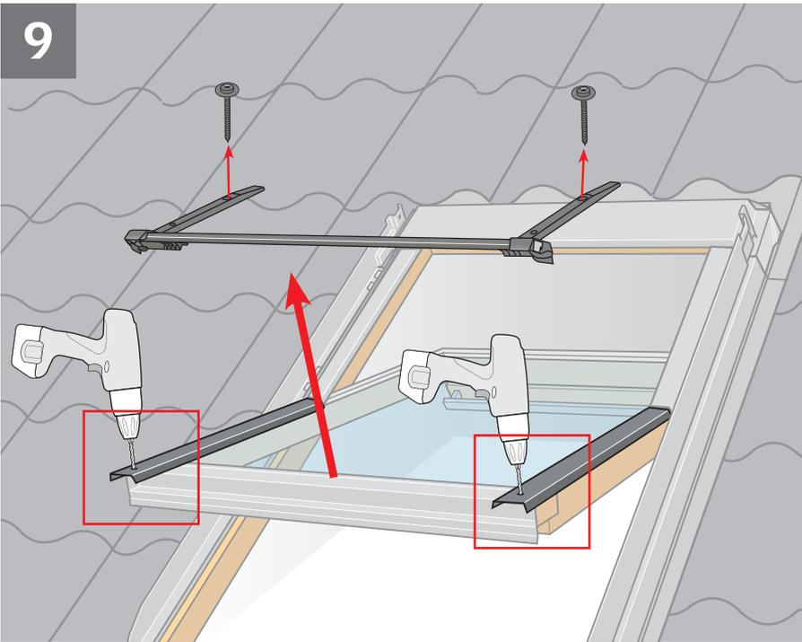
Unteres Abdeckblech vorübergehend entfernen und untere Löcher vorbohren **a**. Dichtungsmaterial auf **alle** Schraubenlöcher kleben **b**.
