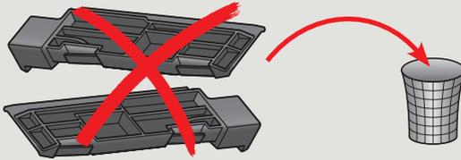
Endstücke vom unteren Abdeckblech entfernen und entsorgen.
