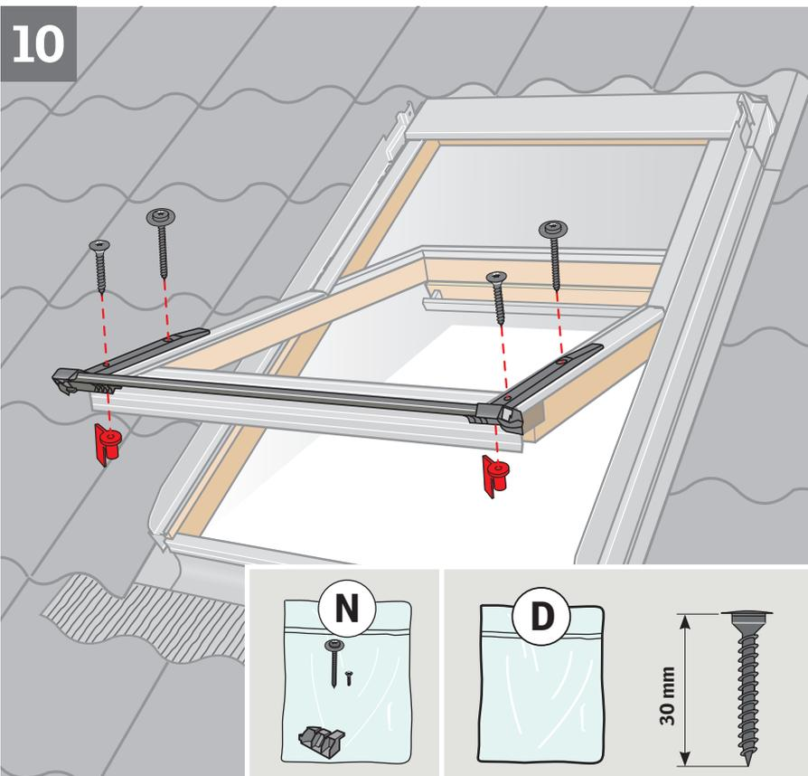
Unteres Abdeckblech montieren. Untere Schrauben in Spezial-Schraubenmuttern befestigen.
