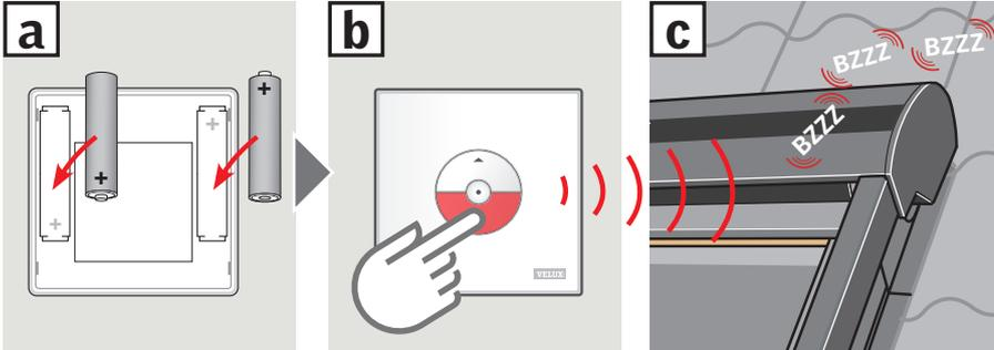
Batterien in den Funk-Wandschalter einsetzen **a**. Die HERUNTER-Taste drücken **b** wonach ein dreimaliges Motorengeräusch die Funktionsfähigkeit signalisiert **c**.
