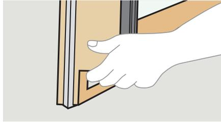
Flügel wieder einhängen. Der Druckknopf rastet beim Schließen des Flügels automatisch aus.
