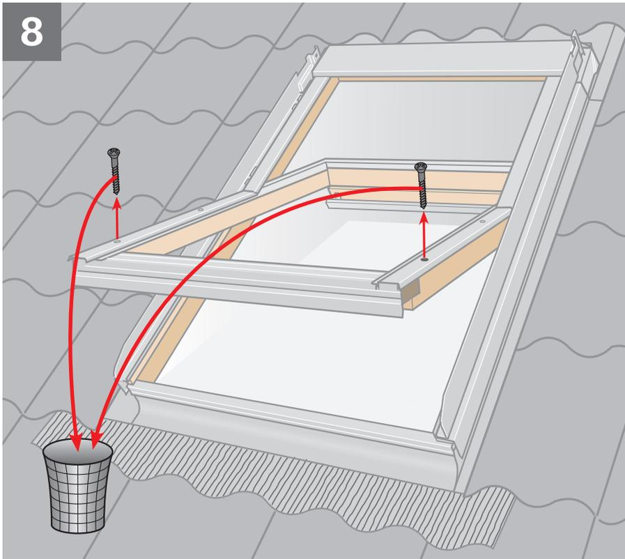
Gezeigte Schrauben entfernen.
