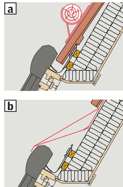
Zur Vermeidung von Schäden durch Schnee am Rollladen, die ortsübliche Baupraxis und die bekannten Regelwerke berücksichtigen. Beispiele von Schutzmaßnahmen: Schneefangnase **a**), Schneerechen **b**).
