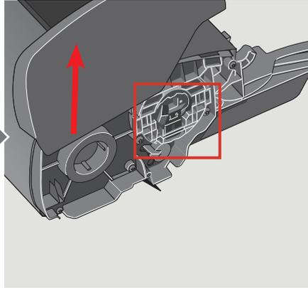
Kunststoffdeckel entfernen **a**. Schalter in Position I rücken **b**. Kunststoffdeckel wieder montieren **c**.
