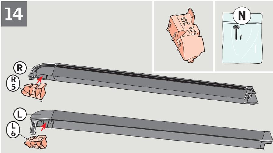
Kunststoffteile in die seitlichen Führungsschienen des Rollladens einsetzen **a**, **b**.
