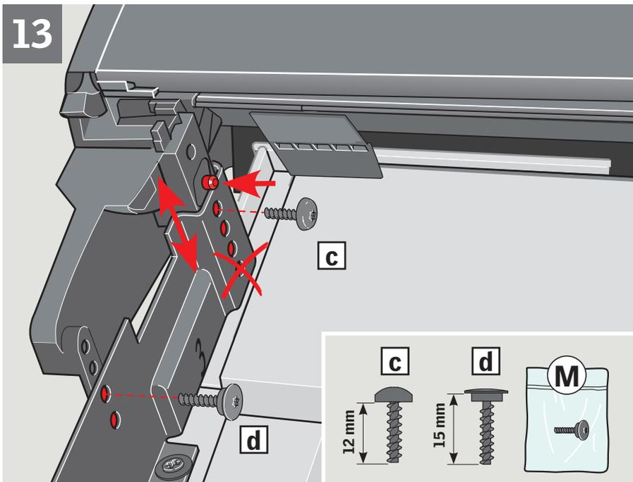
Das Rollladen-Oberteil so weit wie möglich in Richtung Fenster herunterdrücken, das Dachmaterial darf jedoch **nicht** berührt werden **a**, **b**! Nach Montage des Rollladen-Oberteils die Sicherungsschrauben eindrehen **c**, **d**.
