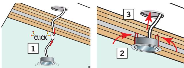
**ČESKY:** Zapojte kabely do halogenových reflektorů (1) a připevněte stisknutím svorek na bocích směrem nahoru (2) zatímco usazujete reflektory do jejich otvorů (3).
