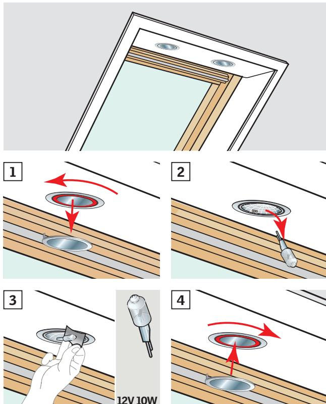
**ČESKY:** Uvolněte krycí sklo otočením vnitřního kruhu proti směru hodinových ručiček (1). Vyjměte žárovku (2). Vložte novou žárovku.
