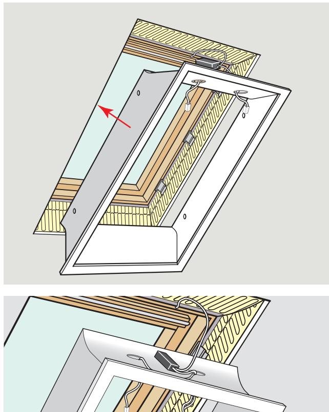
**ČESKY:** Ved'te kabely s připojkou pro halogenové reflektory z tlumiče světla přes jejich otvory dovnitř ostění.
