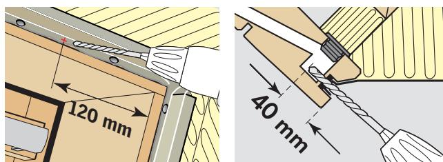
**ČESKY:** Vyvrtejte otvor do drážky rámu pro vedení kabelu. Vyhnete se vrtání ve spodní hraně vrchního rámu.
