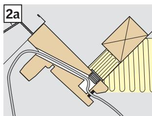
**ČESKY:** Pokud byl na pravé straně okna upevněn černý krycí profil, dočasně jej odstraňte (1). Otevřete okno do čistící polohy. Vedte otvorem kabel tlumiče světla (2, 2a).
