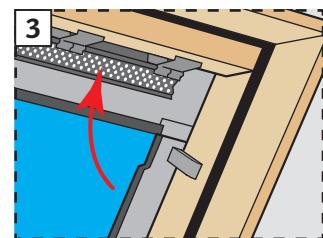
**ČESKY:** Zapojte kabel tlumiče světla do spojovacího boxu na okně (1). Utěsněte otvor a pomocí svorek kabel připevněte (2). Pokud byl na pravé straně okna upevněn černý krycí profil, znova jej upevněte (3). Zavřete okno. Tlumič světla se sadou kabelů musí zůstat uvnitř.
