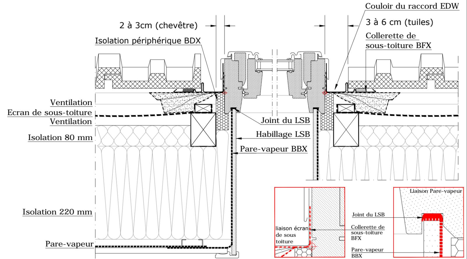
**Verrière VELUX GPL avec la fenêtre fixe GIL sur tuiles mécaniques avec raccords EDW et ETW**
