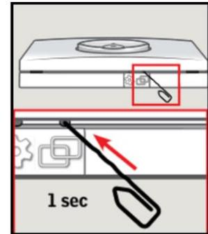
2-Faire un *reset bref* sur les 2 carrés avec un trombone. Le moteur s'associe alors au clavier.
