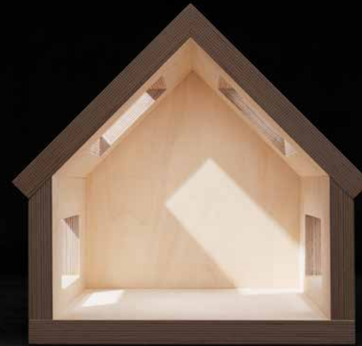
Wenn der solare Wärmegewinn als Energiequelle hinzugezogen wird, kann die Gestaltung offener angelegt werden, sodass die Fenster als Instrument einer passiven Heizung fungieren.
