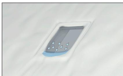
Dando così vita a ristagni d'acqua (piccoli bacini d'acqua) sotto la finestra per tetti. Quest'acqua defluisce attraverso il sottotetto, ma in presenza di un'altezza sufficiente (altezza della soglia) può anche infiltrarsi tra l'anta e il telaio della finestra.
