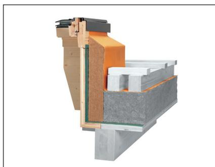
Importante nella sporgenza della finestra per tetti è, anche in questo caso, accertarsi di condurre la barriera vapore, l'isolamento termico e il collegamento mantella d'allacciamento fino al telaio della finestra. Particolare riguardo va riservato alla scelta di un isolamento termico sufficientemente forte.
