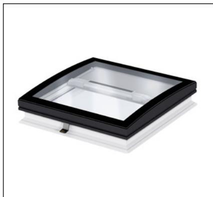
Le marchisette traslucide (MSG) vengono montate tra il vetro e il cupolino e sono comandate ad energia solare tramite telecomando. Assorbimento dell'energia solare attraverso il pannello fotovoltaico integrato e immagazzinamento nella batteria NiMH. Una batteria completamente carica assicura fino a 360 azionamenti (per il superamento dei periodi di maltempo). Esse garantiscono temperature confortevoli trattenendo i raggi intensi del sole prima che questi raggiungano il vetro.
