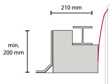
**Beton mit Flachstahl**
