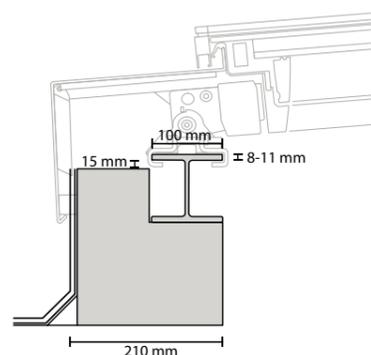
Stahl-, Beton- oder Holz-Unterkonstruktion mit Stahlprofil
