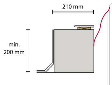
**Beton mit Stahlprofil**
