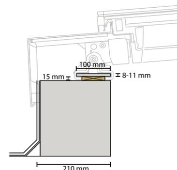
Stahl-, Beton- oder Holz-Unterkonstruktion mit Flachstahl
