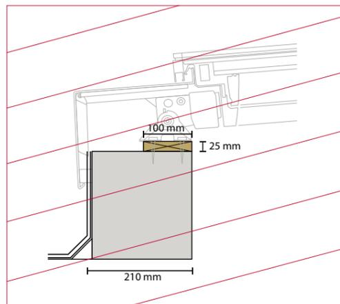
Stahl, Beton oder Holz Unterkonstruktion mit Holzleiste
