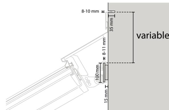
Stahl-, Beton- oder Holz-Unterkonstruktion mit Flachstahl
