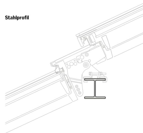
**Träger mit Flachstahlprofil**
