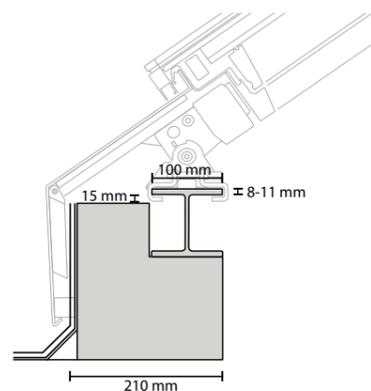
Stahl-, Beton- oder Holz-Unterkonstruktion mit Stahlprofil
