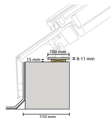
Stahl-, Beton- oder Holz-Unterkonstruktion mit Flachstahl
