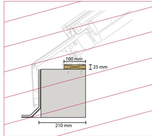
Stahl, Beton oder Holz Unterkonstruktion mit Holzleiste
