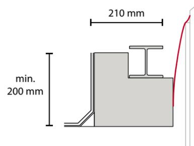
**Beton mit Flachstahl**
