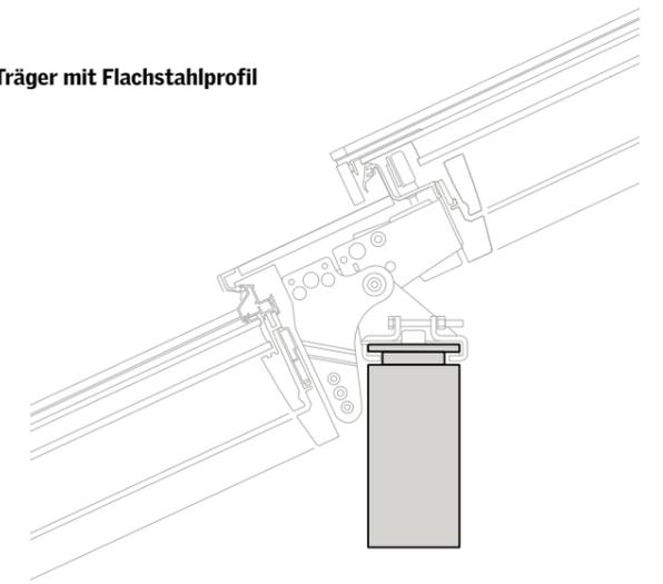
\*Die Träger können auch gekippt, also senkrecht zu den Modulen (zur Modulneigung) installiert werden. In diesem Fall ist keine der Maß-Angaben in diesem Dokument korrekt. Die entsprechenden Werte sind beim lokalen VELUX Commercial Vertriebsbüro abzufragen.
