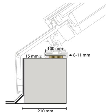
Stahl-, Beton- oder Holz-Unterkonstruktion mit Flachstahl
