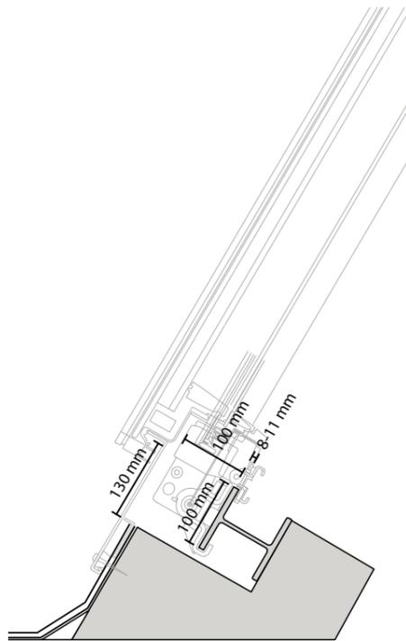
Beton-Konstruktion mit Stahlprofil
