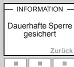
**Hinweis:** Die Sperre lässt sich aufheben, indem über das externe Steuergerät die Funktionen ▲ und ▼ gleichzeitig aktiviert werden.
